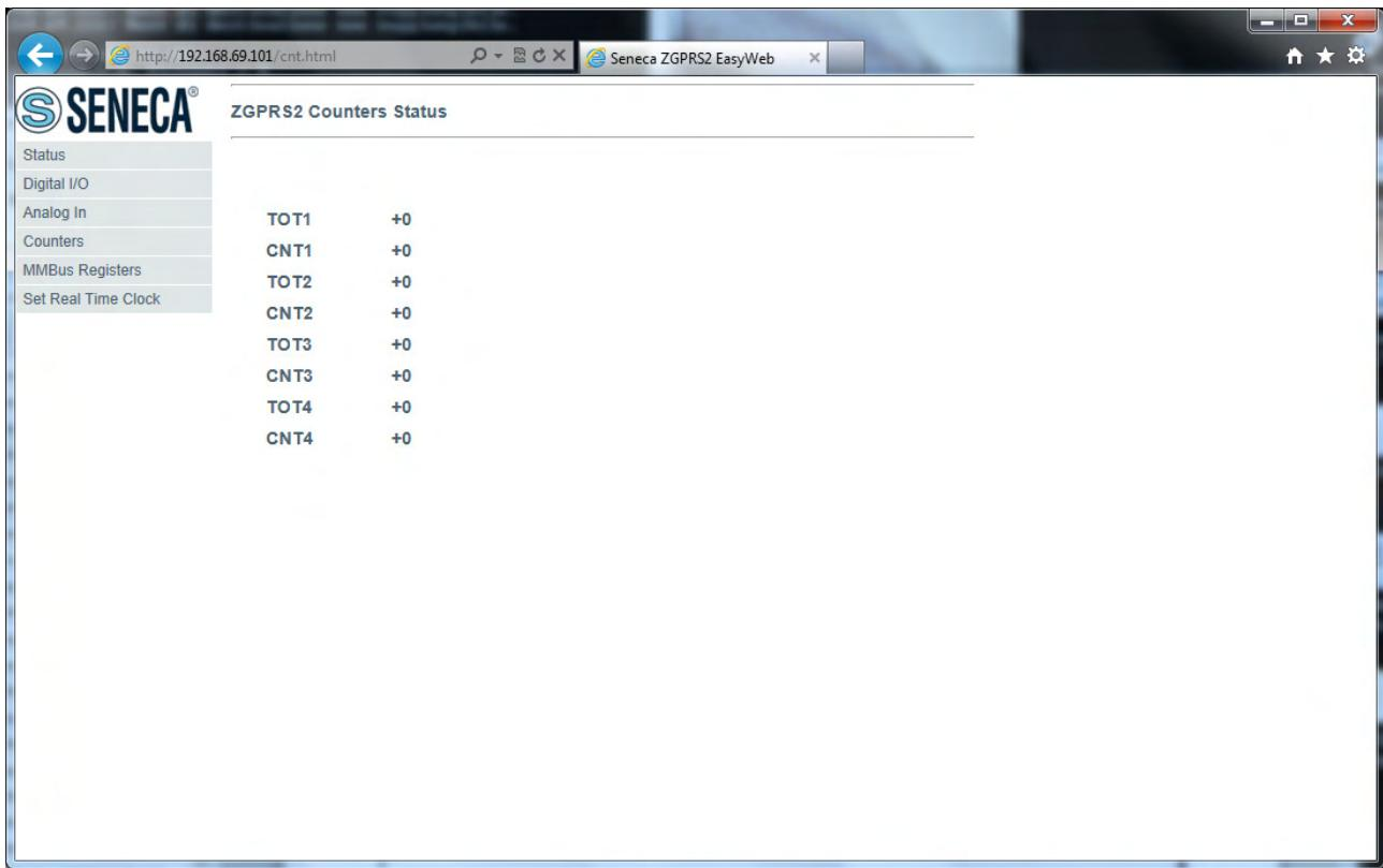
La pagina “MMBUS REGISTERS” riporta i valori loggati in tempo reale dei TAG Modbus (sia Modbus TCP-IP e Modbus RTU):
