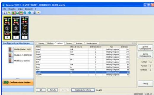
Fig. 5.2. Configurazione moduli I/O slave tramite Z-NET3
