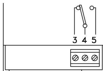
Il rele' di uscita, ad uno scambio SPDT con portata 250Vca 5A (carico resistivo), è normalmente attratto per garantirne la caduta in caso di mancanza di tensione di alimentazione o di guasto.
