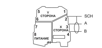
**Последовательный порт со стороны Y: полудуплексная передача по интерфейсу RS485**
