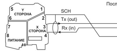
**Последовательный порт со стороны Y: полудуплексная передача по интерфейсу RS485**
