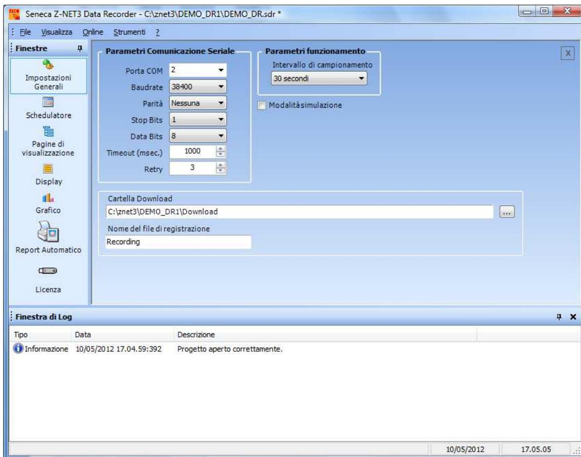
5. Dalla sezione Impostazioni Generali, è possibile controllare/modificare i parametri di comunicazione Modbus RTU/Modbus TCP (PORTA COM e Baudrate oppure INDIRIZZO IP e porta TCP) ed il percorso del file xxxxx.mdb creato dal DataRecorder durante la registrazione.
