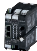
RTU / Gateway Edge IIoT
