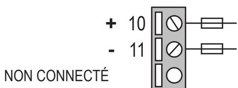
L'alimentation doit être raccordée aux bornes 10 et 11.
