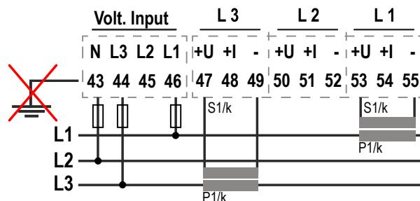
ATTENTION ! Le raccordement à la terre via la borne 43 est interdit.
