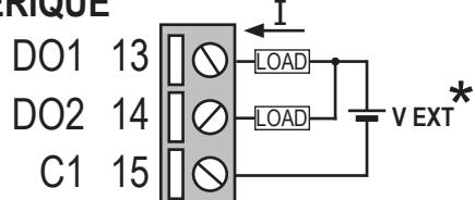
L'appareil dispose de deux sorties numériques.
