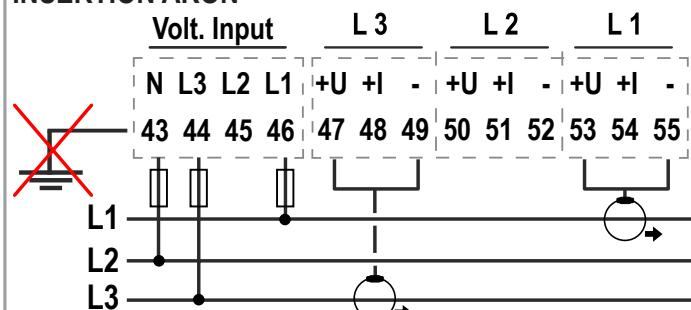
**ATTENTION !** Le raccordement à la terre via la borne 43 est interdit.
