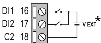
L'appareil est équipé de deux entrées numériques pouvant être activées par une tension de 12 à 24 V. Voir le manuel de l'utilisateur pour le détail des fonctionnalités.
