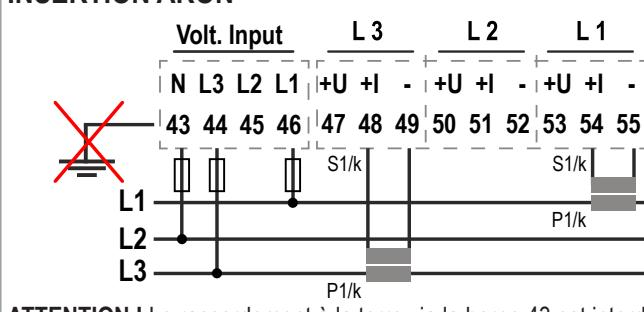
**ATTENTION !** Le raccordement à la terre via la borne 43 est interdit.
