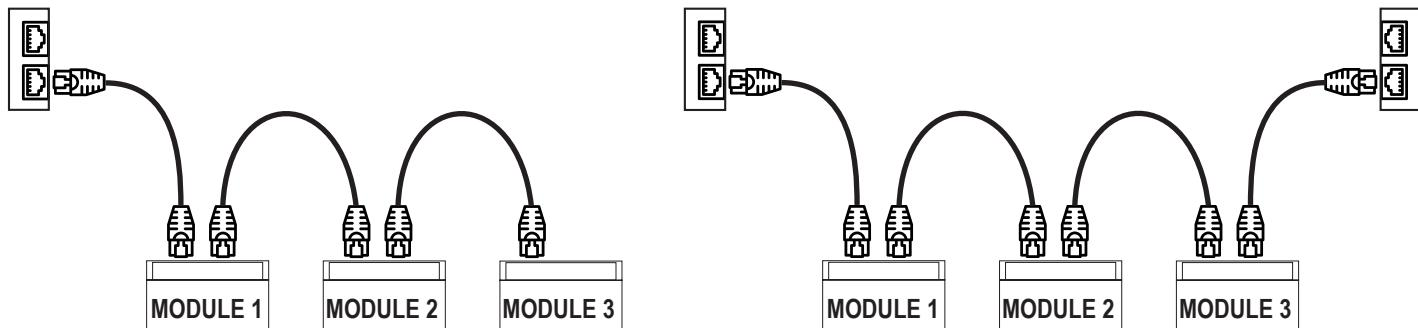
No debe haber bucles en el cableado Ethernet, de lo contrario fallará la comunicación. Los módulos e interruptores deben conectarse eliminando los bucles. En los siguientes ejemplos se muestran las conexiones incorrectas.
