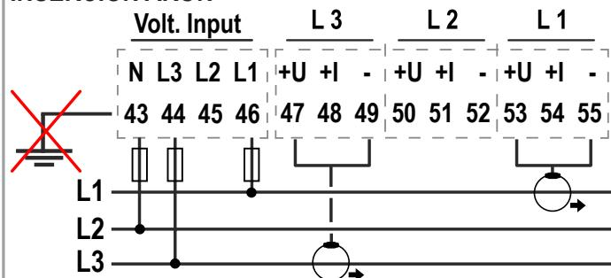
**ATENCIÓN!** Está prohibido realizar la conexión a tierra mediante el terminal 43.
