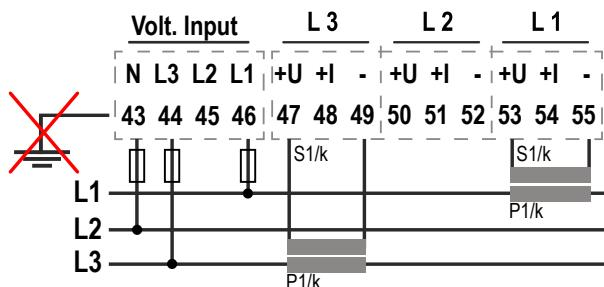
ATENCIÓN! Está prohibido realizar la conexión a tierra mediante el terminal 43.
