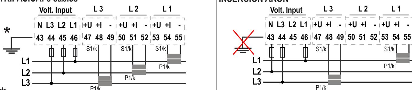
**ATENCIÓN!** Está prohibido realizar la conexión a tierra mediante el terminal 43.
