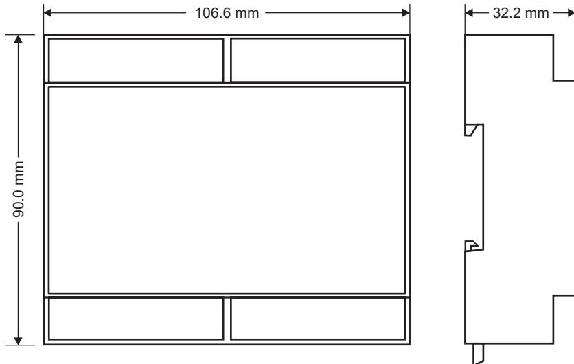
**Peso** 170 g; **Contenedor:** Material PC/ABS autoextinguible según UL94-V0, color negro.
