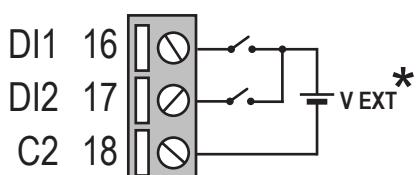
El dispositivo está equipado con dos entradas digitales que pueden activarse con una tensión de 12 a 24 V. Consultar el manual de usuario para conocer sus funciones.
