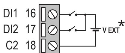
Das Gerät verfügt über zwei digitale Eingänge, die mit Spannung von 12 bis 24 V aktiviert werden können. Zur Funktionsweise siehe das Benutzerhandbuch.
