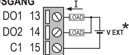
Das Gerät verfügt über zwei digitale Ausgänge.
