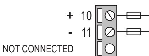
Die Stromversorgung muss an die Kontakte 10 und 11 angeschlossen werden.
