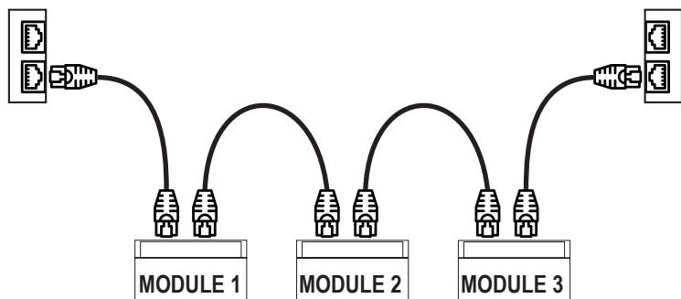
Die Ethernet-Verkabelung darf keine Loops aufweisen; anderenfalls funktioniert die Kommunikation nicht. Die Module und Switches müssen unter Vermeidung von Loops angeschlossen werden. Die folgenden Beispiele zeigen die falschen Verbindungen.
