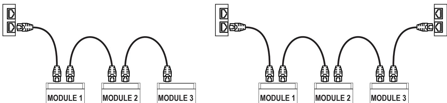
Non devono essere presenti loop nel cablaggio Ethernet: in caso contrario, la comunicazione non funzionerà. È necessario collegare moduli e switch eliminando i loop. Gli esempi che seguono mostrano i collegamenti non corretti.
