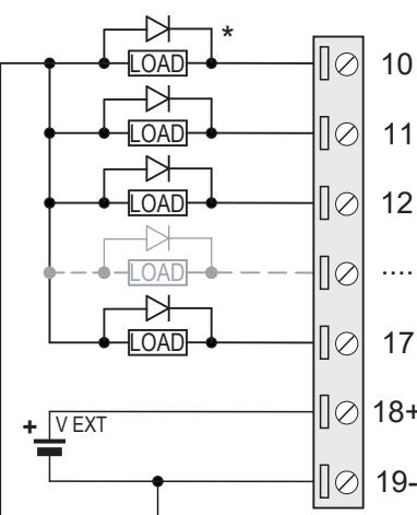
Les sorties numériques doivent être alimentées par une source externe pour fonctionner correctement (V EXT).
