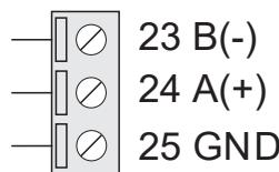
Raccordement au port RS485.
