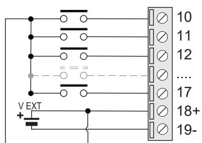
Les entrées numériques doivent être alimentées par une source externe pour fonctionner correctement (V EXT).
