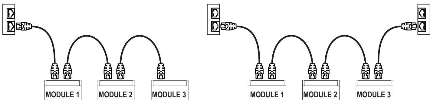
Les câbles Ethernet ne doivent pas comportés de boucles sous peine d'un dysfonctionnement de la communication. Les modules et les commutateurs sont branchés en éliminant les boucles. Les exemples suivants indiquent les branchements incorrects.
