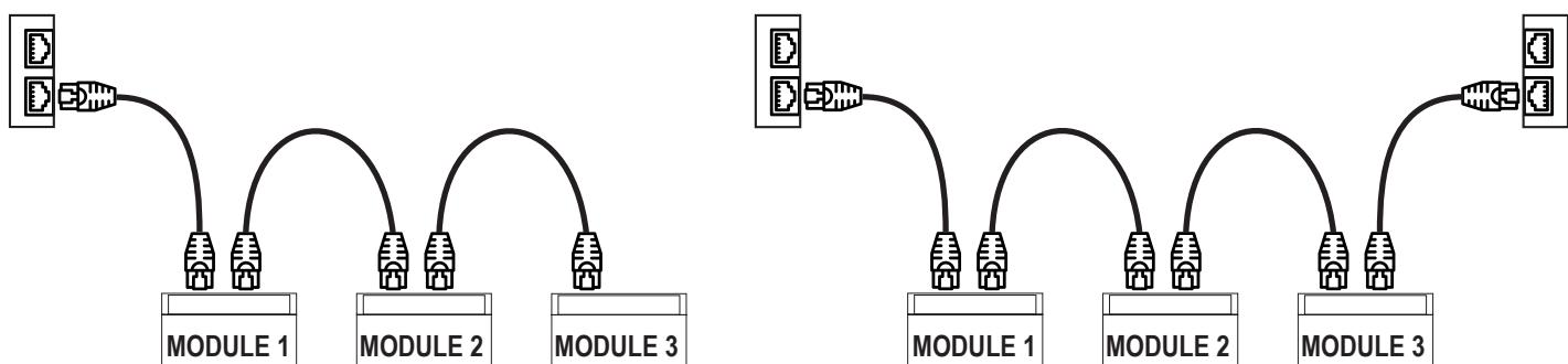
Nei cablaggi ethernet non devono essere presenti loop, pena il mancato funzionamento della comunicazione. I moduli e gli switch vanno collegati eliminando i loop. Nei seguenti esempi sono raffigurati i collegamenti errati.
