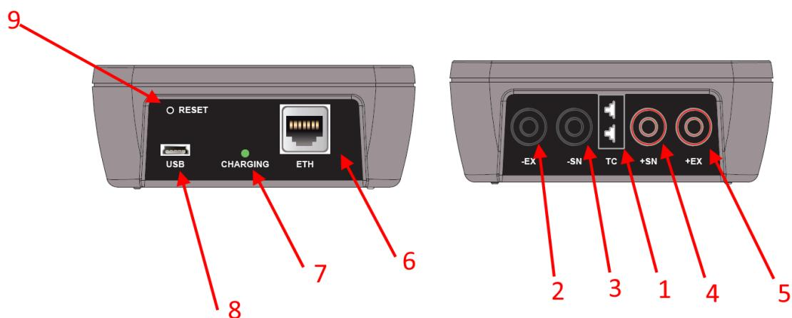
1 Presa per misura/generazione termocoppia
