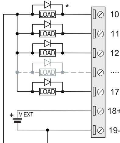
Las salidas digitales deben ser alimentadas externamente para funcionar correctamente (V EXT).
