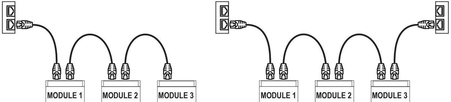
No debe haber bucles en el cableado Ethernet, de lo contrario fallará la comunicación. Los módulos e interruptores deben conectarse eliminando los bucles. En los siguientes ejemplos se representan las conexiones incorrectas.
