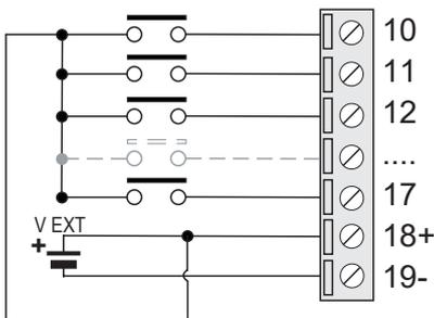
Las entradas digitales deben ser alimentadas externamente para funcionar correctamente. (V EXT)
