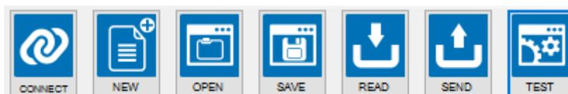
**Connetti:** utilizzare l'icona di connessione per collegare il PC al dispositivo. Tener presente che è necessario specificare se il collegamento viene eseguito da bus RS485 o da USB frontale. Per collegare il dispositivo a un PC e configurare il dispositivo dal bus RS485 è necessario utilizzare un convertitore come il Seneca S117P1 o S107USB.
