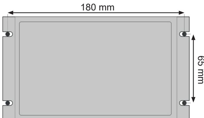
Percez 4 trous pour les vis (diamètre 5 mm maximum), en respectant les distances indiquées sur la figure. Fixez le dispositif à l'aide d'éléments de fixation appropriés (vis ou rivets). Veillez à ne pas faire tomber l'appareil pendant les opérations de fixation afin de ne pas l'endommager. Le montage dans la partie inférieure du tableau de distribution est recommandé.
