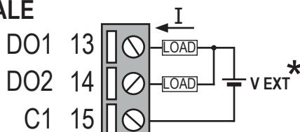
Il dispositivo è dotato di due uscite digitali.
