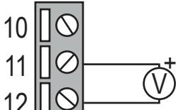
Il dispositivo fornisce un'uscita in tensione (0  $\div$  10 Vdc) o corrente attiva o passiva (0  $\div$  20 mA) programmabile.
