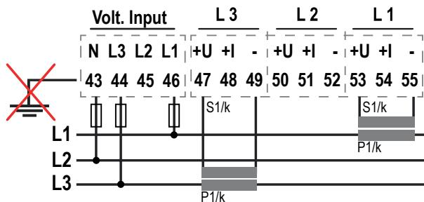
ATTENZIONE! Il collegamento a terra tramite il morsetto 43 è vietato.
