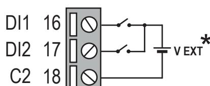
Il dispositivo è dotato di due ingressi digitali attivabili con tensione da 12 a 24 V. Vedi manuale utente per le funzionalità.
