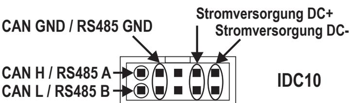
**Hintere Steckverbindung (IDC 10)**
