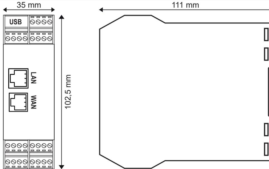
Abmessungen doppeltes Modul LxHxT: 35 x 102,5 x 111 mm; Gewicht: 240 g; Gehäuse: PA6, schwarz
