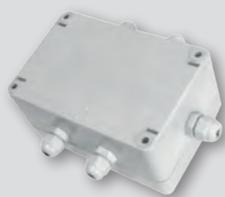
SG-EQ4 è un junction-box / equalizzatore per connettere ai sistemi di pesatura più celle di carico. Le celle di carico devono essere connesse elettricamente in modo tale che le linee di segnale (output), excitation (alimentazione) e sense (quando presente) siano in parallelo.
