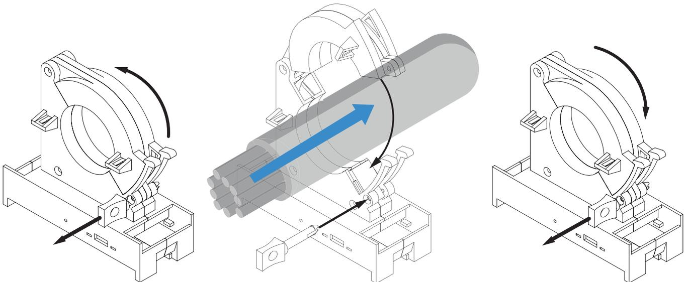
Retirez la fiche de blocage pour permettre l'ouverture de l'instrument. Lors de la première utilisation, l'instrument n'est pas bloqué par la fiche.
