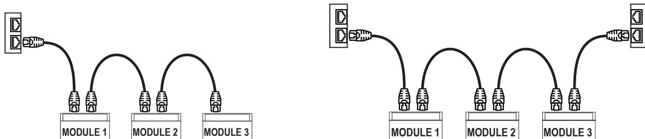
Les câbles Ethernet ne doivent pas comportés de boucles sous peine d'un dysfonctionnement de la communication. Les modules et les commutateurs sont branchés en éliminant les boucles. Les exemples suivants indiquent les branchements incorrects.
