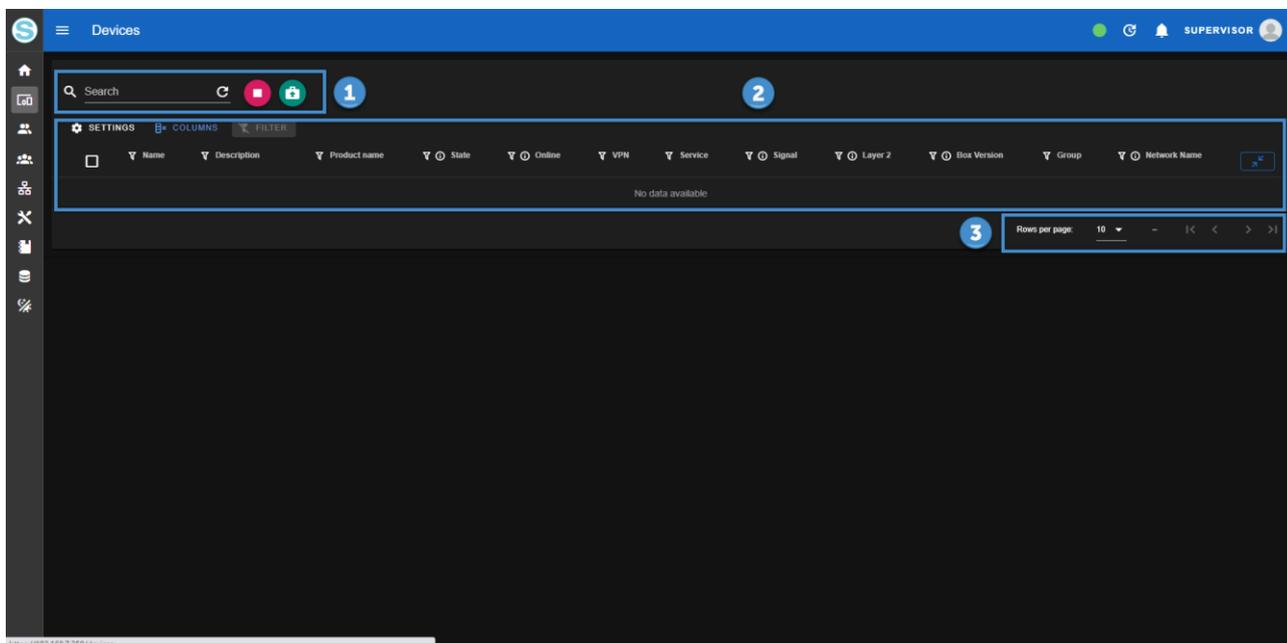
Una volta configurati in locale tramite il proprio Web Server, i dispositivi Seneca si registreranno sul VPN BOX2 e compariranno in questa sezione: questa operazione potrebbe richiedere fino a 2 minuti in caso di scarsa qualità del canale di comunicazione server-device.
