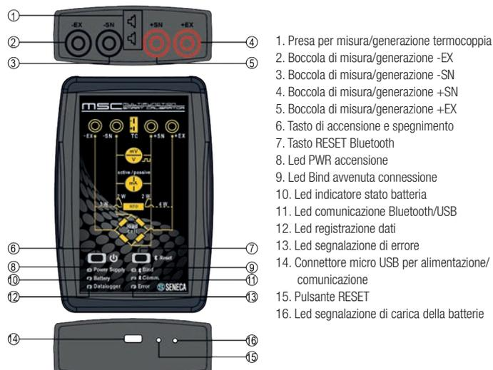
1. Presa per misura/generazione termocoppia
