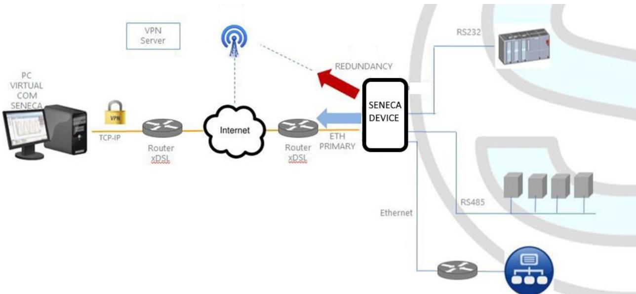
La "Ridondanza di rete" (network redundancy) è una funzionalità che può essere abilitata sui dispositivi dove è disponibile un modem mobile oppure il WI-FI.
