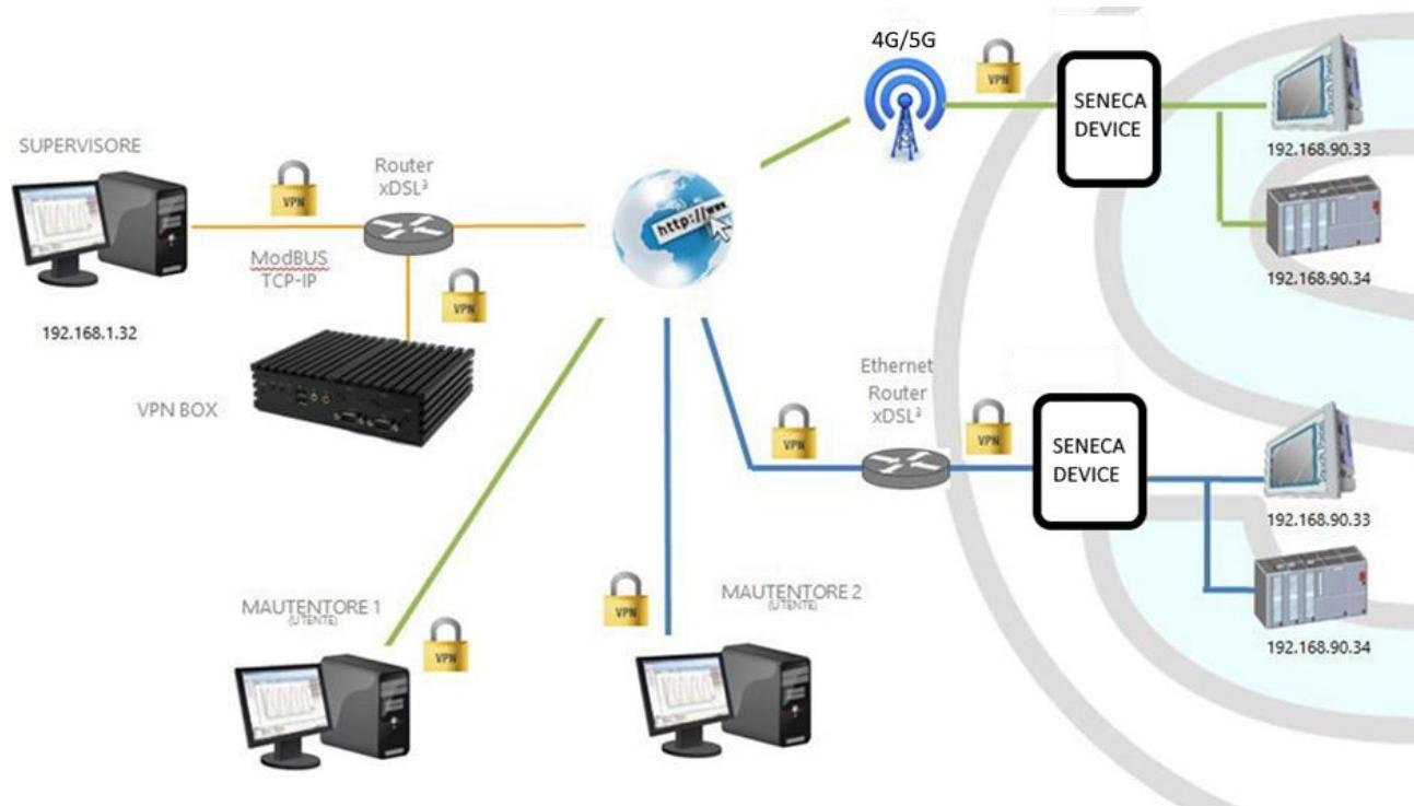
La figura sopra riportata fornisce un esempio di VPN "Point-to Point".
