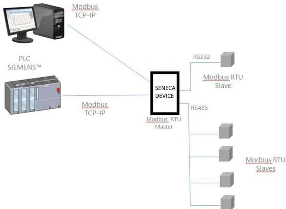
Nella figura sopra, due porte seriali sono configurate come Modbus RTU Master.
