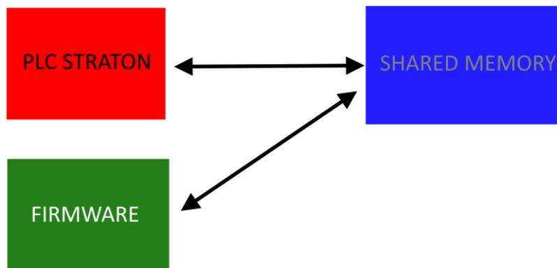
In questa modalità è possibile attivare il datalogger gli allarmi, il display / display virtuale e i protocolli di comunicazione già presenti nel firmware e di leggere e scrivere i TAG direttamente dal PLC.
