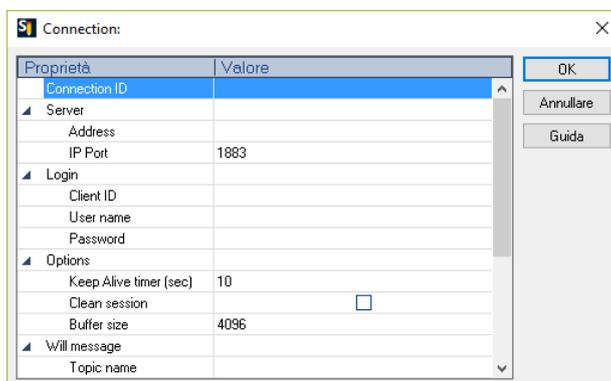
Se fosse necessario configurare questi parametri dal programma Straton PLC, è possibile utilizzare una serie di parole speciali che caricheranno la configurazione da un file.
