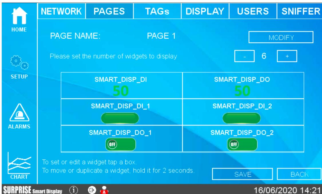
È possibile modificare sia il nome della pagina sia il numero di widget che devono essere visualizzati. Nella parte centrale è riportata una anteprima della visualizzazione della pagina. Ora facendo una pressione su un widget qualsiasi è possibile modificare il tipo di widget, il colore, etc...
