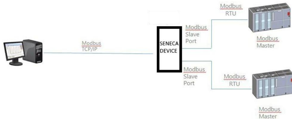
Nella figura sopra, due porte seriali sono configurate come Modbus Slave e collegate ad una porta PLC Modbus Master; in questo modo, i due PLC e il Modbus TCP Client possono scrivere/leggere la memoria condivisa per condividere i dati tra loro.
