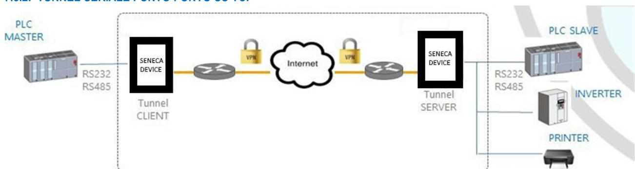
Il tunnel seriale punto punto consente di estendere una connessione seriale tra due dispositivi seriali che supportano lo stesso protocollo tramite una connessione TCP/UDP.
