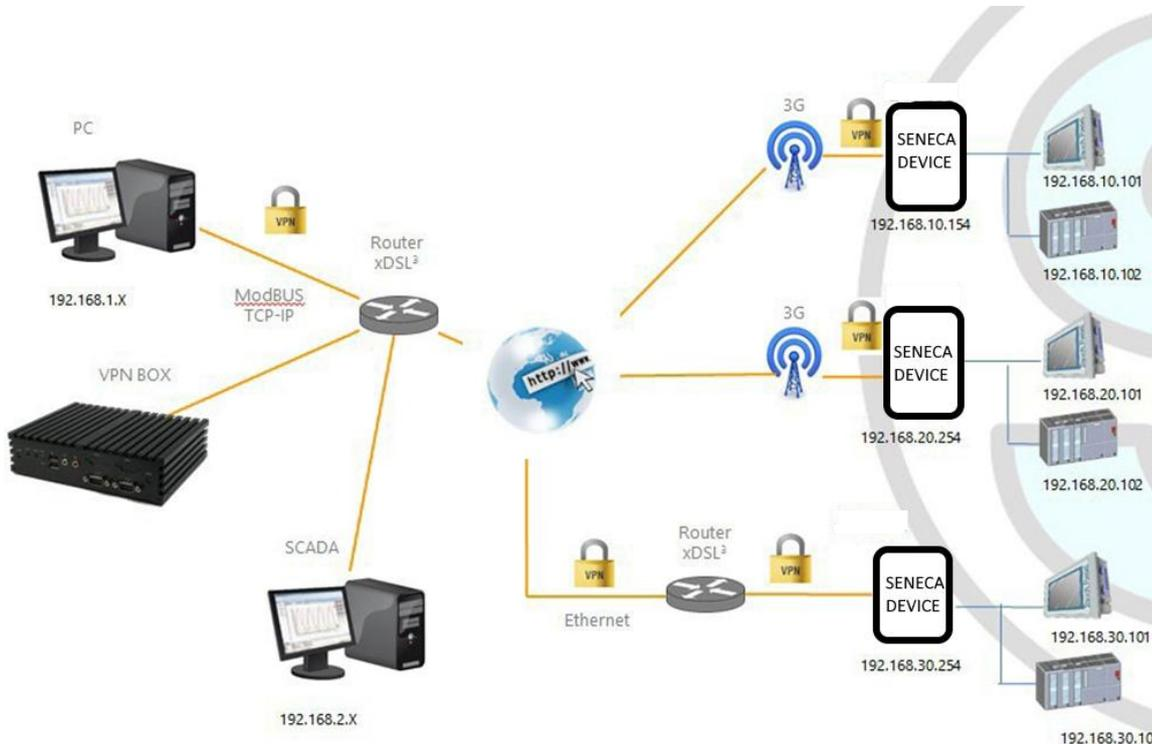
La figura sopra riportata fornisce un esempio di VPN
