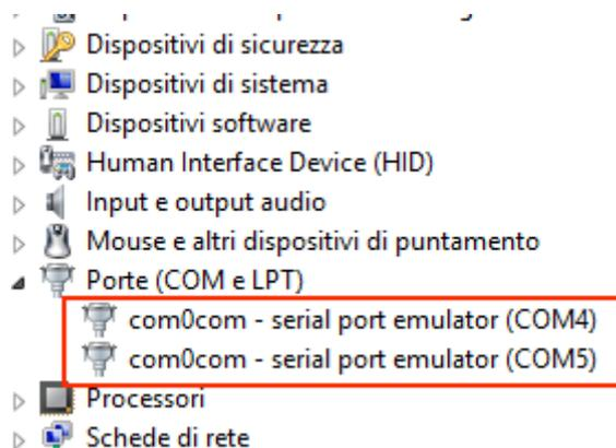
Il software utilizzerà una sola porta (la porta corretta nel setup di com0com), verranno visualizzate solo le porte com0com.
