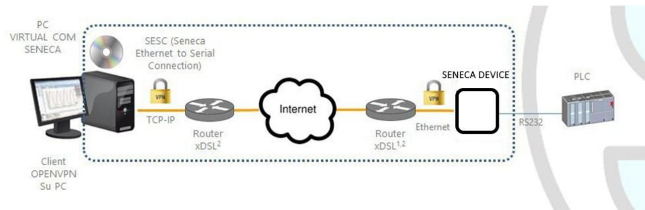
La funzionalità Virtual COM con supporto RFC 2217 permette ad un'applicazione PC, che trasmette i dati solo su una linea seriale, di comunicare con un dispositivo seriale remoto, utilizzando Ethernet/Internet; in altre parole, attraverso il dispositivo Seneca, un PC e un dispositivo seriale, collocati in siti distanti tra loro, possono comunicare in quanto direttamente collegati.
