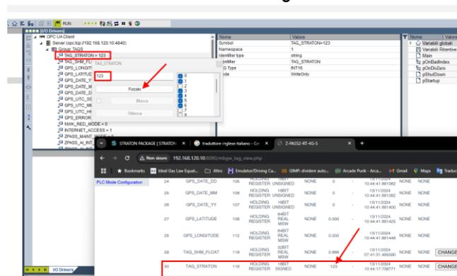
Ora scriviamo un I/O embedded da Straton, modifichiamo il TAG ad esempio del DO2 in WriteOnly:
