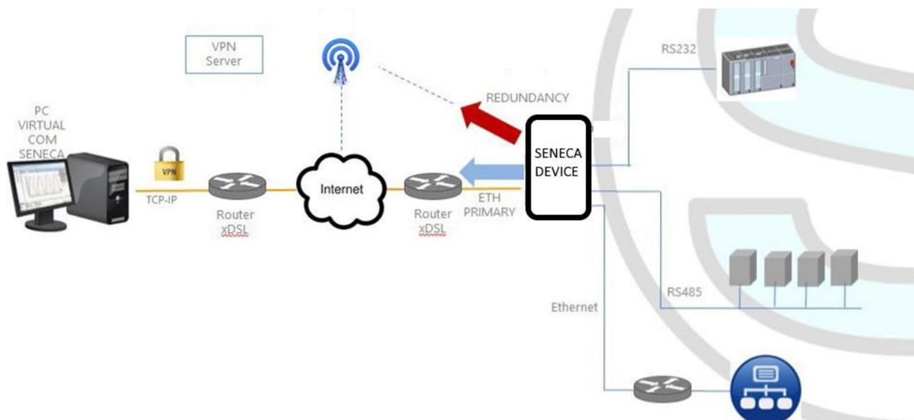
La "Ridondanza di rete" (network redundancy) è una funzionalità che può essere abilitata sui dispositivi dove è disponibile un modem mobile oppure il WI-FI.
