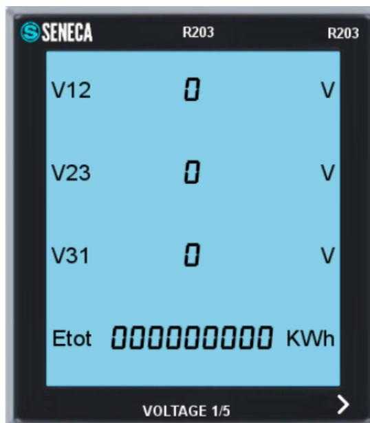
Si tratta di un display virtuale, scorrere le pagine del display virtuale premendo la freccia ">" in basso a destra. È possibile posizionare fino a 2 display virtuali per ogni pagina dei widget.
