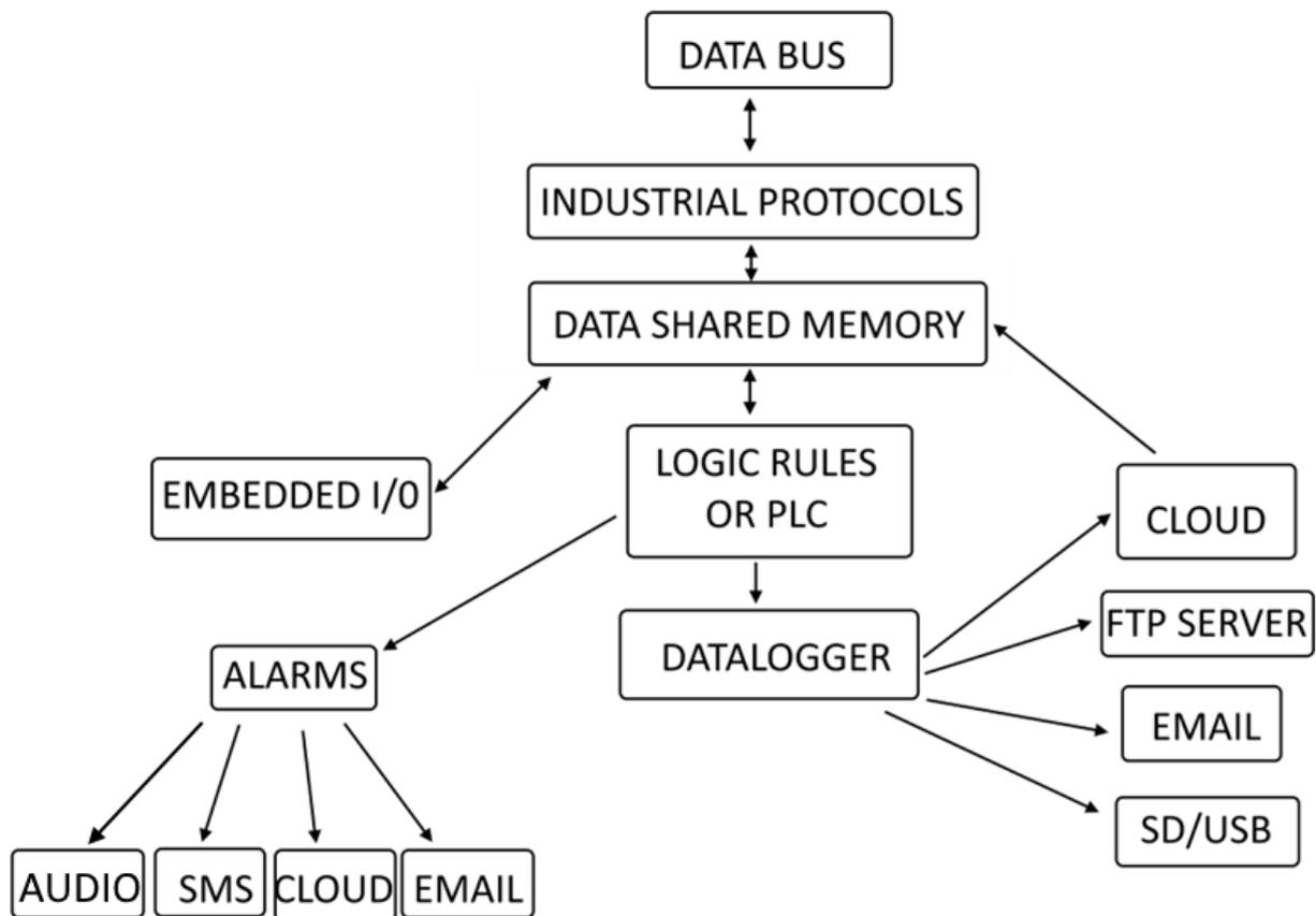
L'acquisizione dei dati (Tag) nei bus (Data Bus) avviene attraverso i protocolli industriali (Industrial Protocol) o tramite acquisizione diretta degli I/O integrati (Embedded I/O).
