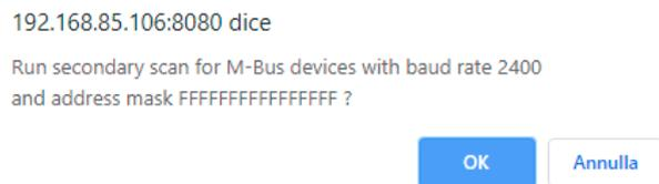
Il completamento della procedura di scansione potrebbe richiedere diversi minuti, quindi la pagina mostra il numero di secondi trascorsi; i dispositivi vengono visualizzati in termini di indirizzo secondario e baud rate non appena vengono rilevati.
