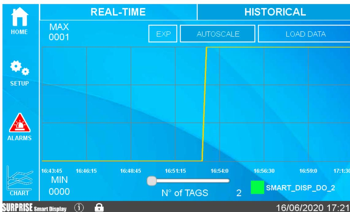
È anche possibile esportare i valori del grafico che si stanno visualizzando tramite la pressione del pulsante “EXP” nel caso sia inserita una chiavetta USB il file sarà salvato.
