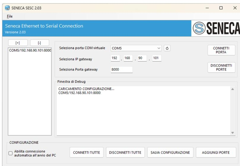
Ora utilizzate la stessa COM5 (ad esempio nel software terminale)
