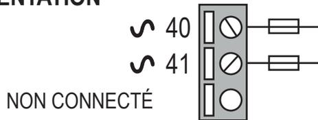
L'alimentation doit être branchée aux bornes 40 et 41.
