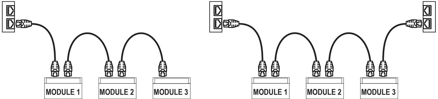
Les câbles Ethernet ne doivent pas comportés de boucles sous peine d'un dysfonctionnement de la communication. Les modules et les commutateurs sont branchés en éliminant les boucles. Les exemples suivants indiquent les branchements incorrects.
