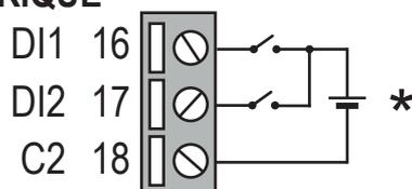
Le dispositif est muni de deux entrées numériques pouvant être activées avec une tension allant de 12 à 24 V. Se reporter au manuel utilisateur pour les fonctions.
