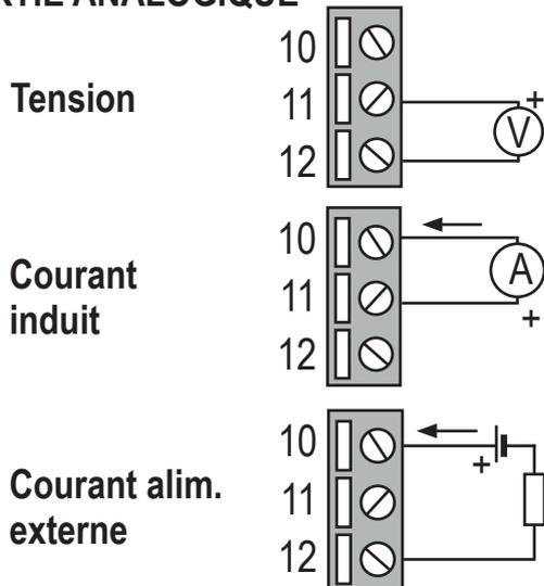
Le dispositif fournit une sortie en tension ( $0 \div 10$  Vcc) ou en courant actif ou passif ( $0 \div 20$  mA) programmable.
