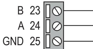
Il n'y a pas d'isolation entre RS485 et la sortie analogique.
