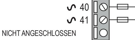
Die Stromversorgung wird an die Klemmen 40 und 41 angeschlossen.
