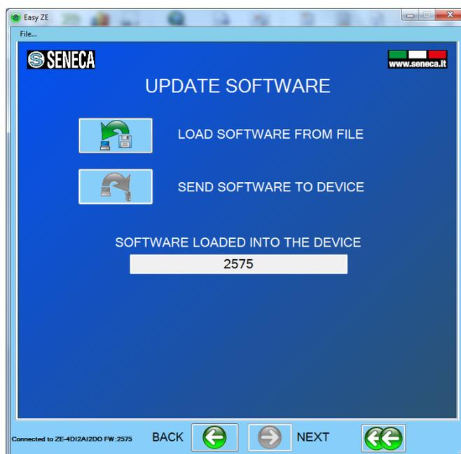
Premere “Load software from file” (Carica il software da file): il software aprirà direttamente la directory del firmware.
