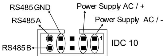
En la figura se reproduce el significado de los varios pin del conector IDC10 en caso en que se desee suministrar las señales directamente mediante el mismo.
