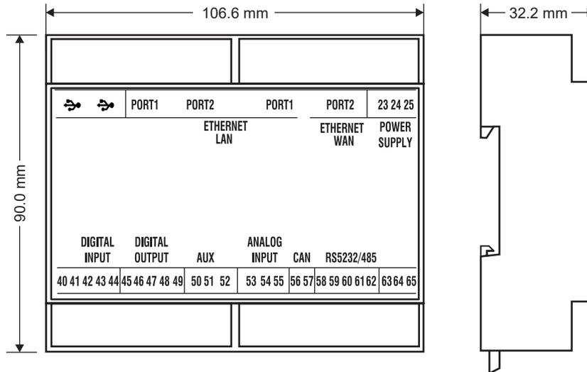
**Gewicht:** 170 g; **Gehäuse:** Material PC/ABS selbstlöschend UL94-V0, schwarz.
