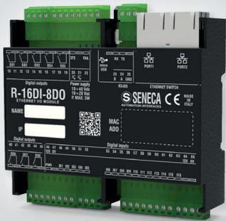
I moduli I/O Serie R sono strumenti studiati per esigenze di cablaggio flessibile, spazi di installazione ridotti, applicazioni ad alta densità di I/O con comunicazione ModBUS / Ethernet / Profinet IO integrate. La configurazione può avvenire tramite software dedicato, web server con il supporto HTML5 e DIP-switch.
