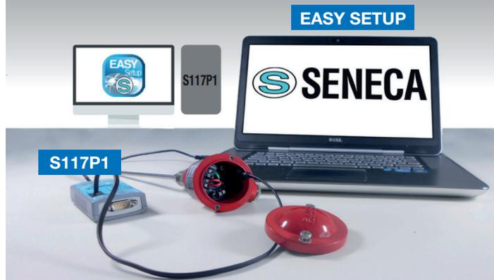
La configurazione dei trasmettitori T120 e T121 montati sulla testa della PT100 può avvenire tramite S117P1, convertitore USB - RS232/TTL e software EASY SETUP. Il modulo può essere configurato anche se non alimentato dal loop 4..20 mA, traendo alimentazione tramite il connettore di programmazione.
