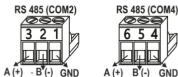
Z-PASS2 tiene dos puertos seriales RS 485 de comunicación: COM 2 y COM 4.
