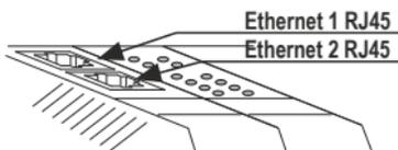
Z-PASS2 tiene dos puertos Ethernet con conector RJ45 en el panel frontal del módulo.
