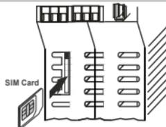
Z-PASS2 cuenta con una ranura para tarjeta SIM ubicada en la parte lateral del contenedor. Para insertar la tarjeta SIM en el conector correspondiente, asegúrese de que esté orientada con los contactos dorados hacia la derecha (como se muestra en la figura de al lado).
