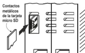
Z-PASS2 tiene una ranura para la tarjeta micro SD, ubicada en la parte lateral del contenedor. La tarjeta microSD o microSDHC se debe insertar con los contactos metálicos orientados hacia la izquierda (como se muestra en la figura). La tarjeta SD puede tener cualquier clase MAX 32 GB. La ranura es de tipo push-push.
