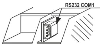
Z-PASS2 proporciona en el conector de 4 polos un puerto serial RS232 o RS485 COM1.
