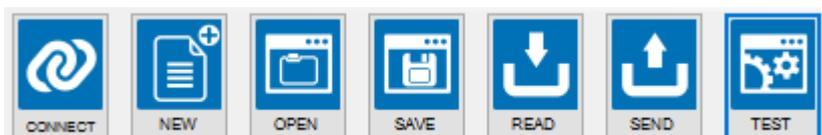
**Connetti:** utilizzare l'icona di connessione per collegare il PC al dispositivo. Per collegare il dispositivo a un PC, è necessario utilizzare un convertitore da RS485 a USB come il Seneca S117P1 o S107USB.
