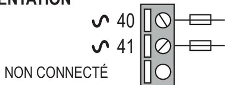
L'alimentation doit être branchée aux bornes 40 et 41.
