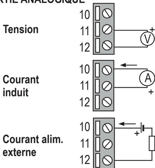
Le dispositif fournit une sortie en tension ( $0 \div 10$  Vcc) ou en courant actif ou passif ( $0 \div 20$  mA) programmable.
