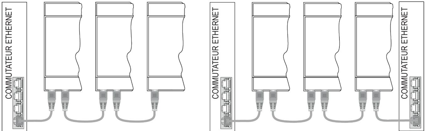
Les câbles Ethernet ne doivent pas comportés de boucles sous peine d'un dysfonctionnement de la communication. Les modules et les commutateurs sont branchés en éliminant les boucles. Les exemples suivants indiquent les branchements incorrects.
