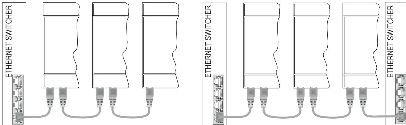
Nei cablaggi ethernet non devono essere presenti loop, pena il mancato funzionamento della comunicazione. I moduli e gli switch vanno collegati eliminando i loop. Nei seguenti esempi sono raffigurati i collegamenti errati.
