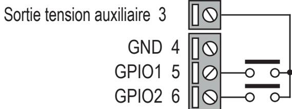
Les entrées sont de type PNP avec une alimentation intérieure, la figure ci-contre montre le branchement. Pour utiliser la fonction INPUT ou OUTPUT, il est nécessaire de configurer le port dédié via la page de configuration dédiée.
