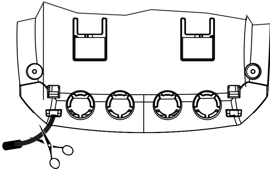
Una vez que se haya retirado la sonda preinstalada, conecte la sonda NTC-150 conectando los cables a los Mo-retti 12 y 13 como se muestra en la siguiente figura.
