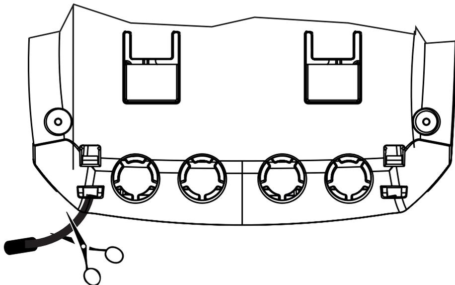
Una volta rimossa la sonda preinstallata, collegare la sonda NTC-150 cablando i cavi ai moretti 12 e 13 come da figura sottostante.
