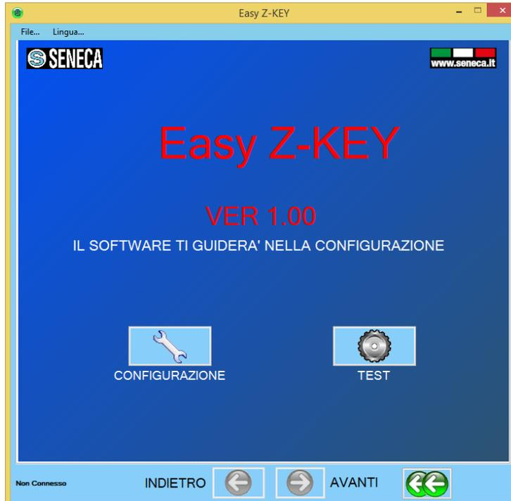
Collegare lo Z-KEY ad un PC con un cavo micro USB standard, accendere la Z-KEY e cliccare su "TEST" per ottenere l'indirizzo IP effettivo:
