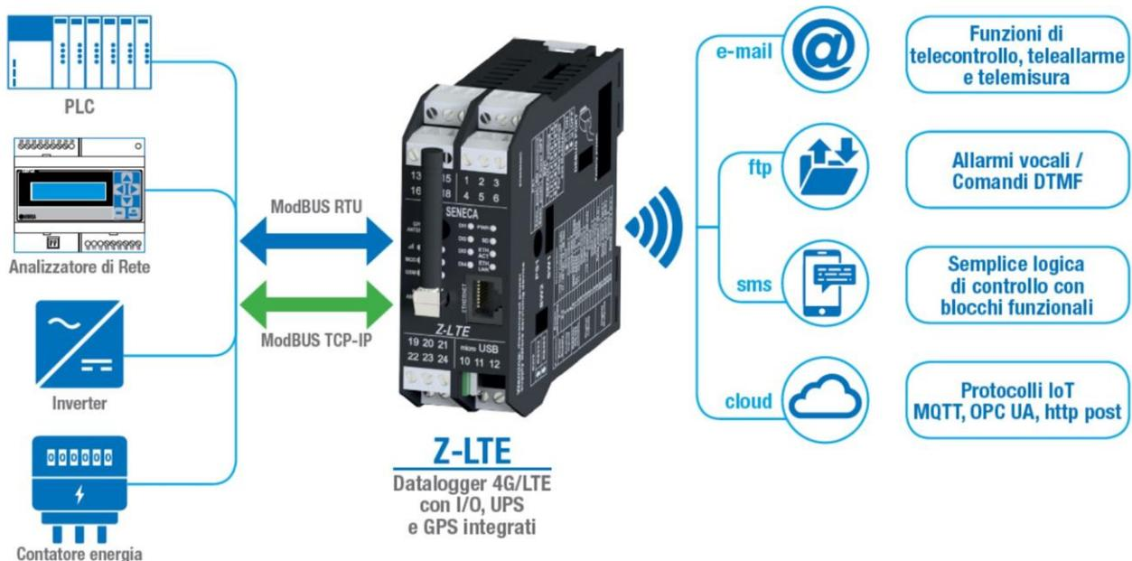
Grazie a un'industrializzazione potenziata e a un nuovo performante modem 4G/LTE con ricevitore GNSS GPS fino a 55 canali, il nuovo datalogger Z-LTE di SENECA è in grado rispondere alle crescenti esigenze di raccolta dati, analisi in tempo reale e integrazione con sistemi IT.
