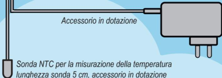
*Sonda NTC per la misurazione della temperatura
