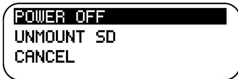
Zum Auswählen des gewünschten Befehls die Taste SCR verwenden, die es gestattet, die verschiedenen Optionen durchzugehen; zum Bestätigen der gewünschten Option die Taste PWR drücken. Es ist außerdem möglich, das Kontextmenü einer Seite aufzurufen, indem die Taste SCR für einige Sekunden gedrückt gehalten wird.
