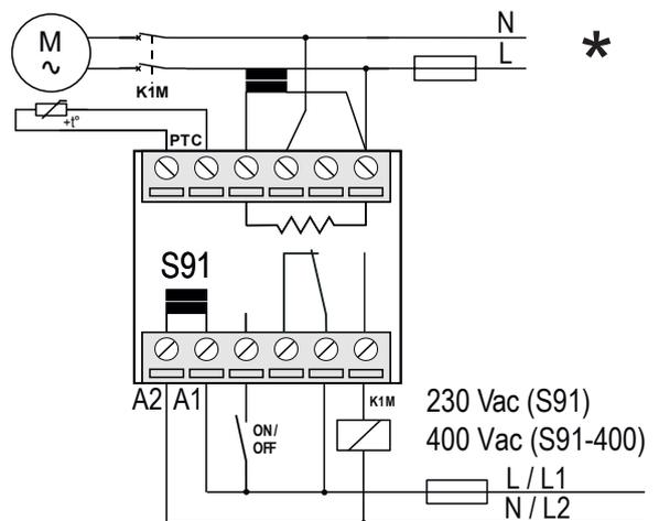
\* In der Nähe des Gerätes muss ein thermomagnetischer Schalter eingesetzt werden.
