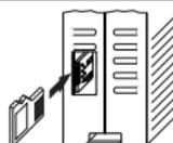
Inserimento della microSD card o della microSDHC, nello slot laterale. MAX 32 GB. Connettore di tipo push-push.
