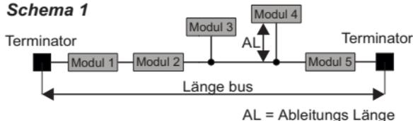
Für die Erzielung der Max Leistungen empfehlen wir die Verwendung von abgeschirmten Spezialkabeln wie zum Beispiel BELDEN 9841.
