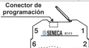
K111D cuenta en el panel frontal con un conector de 4 polos para configurar el dispositivo, como se indica en la figura del lado.
