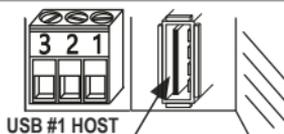
Das Z-PASS1 weist eine Steckkupplung USB HOST vom Typ A auf, in die ein USB-Stick für die Aktualisierung der Firmware eingesteckt werden kann. Max. verfügbarer Strom 100 mA.
