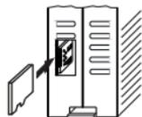
Das Z-PASS1 weist einen Slot für MicroSD Card an der Seite des Gehäuses auf.
