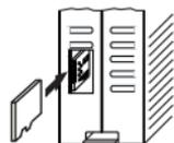
Z-PASS1 cuenta con una ranura para tarjeta micro SD ubicada en la parte lateral del contenedor. La tarjeta micro SD o micro SHDC se debe insertar con los contactos metálicos orientados hacia la izquierda (como se muestra en la figura). La tarjeta SD puede tener cualquier clase MAX 32 GB. La ranura es de tipo push-push.
