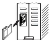
Le Z-PASS1-R02 a un emplacement pour carte micro SD placé sur le côté du boîtier.
